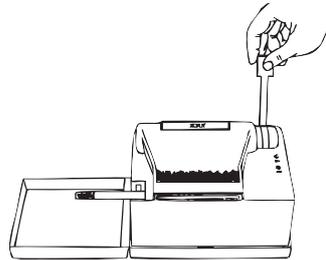
5. Pour enclencher le remplissage du tube, baisser le levier à fond.
